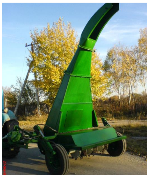
Рис. 2.3. Гичкозбиральна машина КІР-1,5
