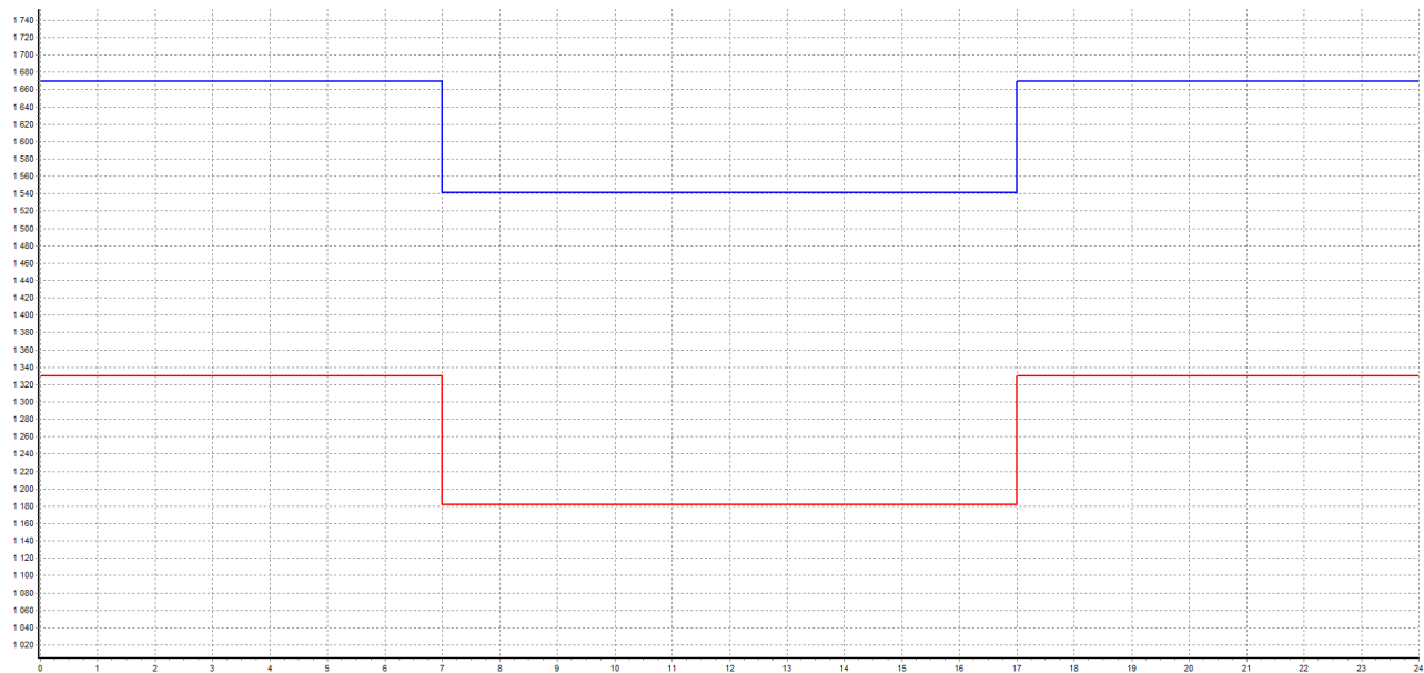
Рис.3.3. Добовий графік навантаження Р, Q (літні вихідні дні)
