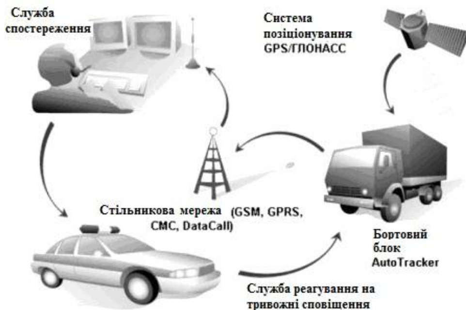
Рисунок 4.1 – Схема роботи системи транспортного моніторингу.
