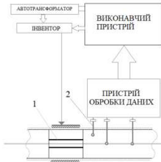
Рис.2.2.2 Конструкція індукційного нагрівача з робочою трубою, де 1-труба, 2 термометр
