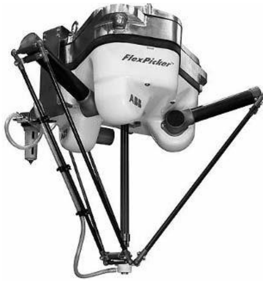
Рис. 1.7. Робот типу «дельта» мод. FlexPicker IRB 340
