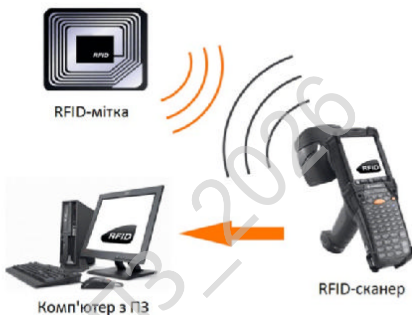
Рисунок 1.1 – Принцип організації та структура системи на основі RFID-технології
