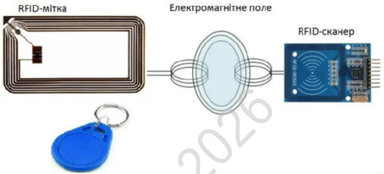
Рисунок 2.6 – Типова схема організації взаємодії між RFID-сканером та RFID-міткою
