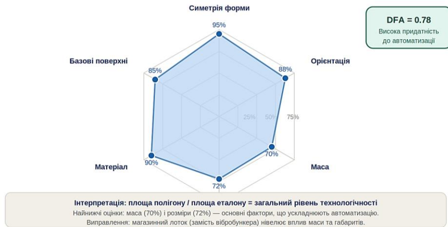
Рис. 2.5 – Радарна діаграма оцінки технологічності деталі за критеріями DFA. Площа полігону відображає загальний рівень придатності до автоматизації
