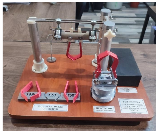
Рис. 3.2. Установа для вимірювання сил затиску ЗП робота (фото автора)
