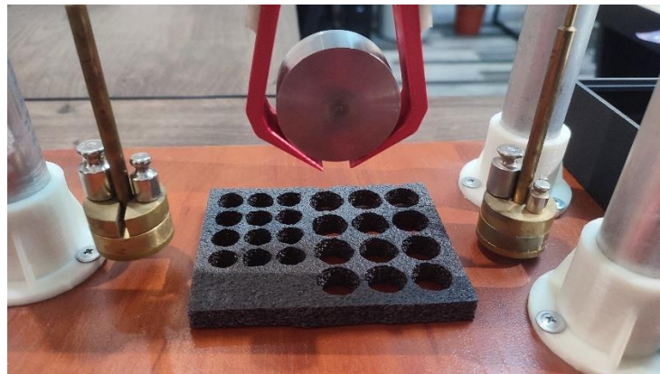
Рис.3.6 Експериментальне вимірювання сил затиску циліндричної ЗП з кутом призми 120^\circ (фото автора)
