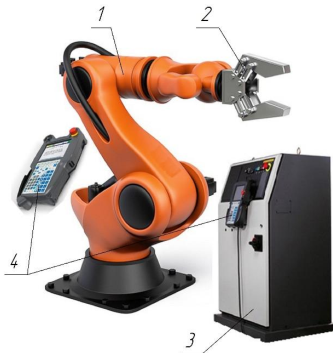
Рис.2.2. Основні складові РМ [6], де: 1 – робот-маніпулятор; 2 – захватний пристрій робота; 3 – блок керування; 4 – пульт керування.
