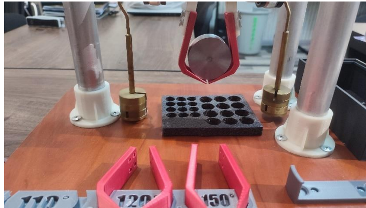
Рис.3.5 Експериментальне вимірювання сил затиску циліндричної деталі в ЗП з кутом призми 110^\circ (фото автора)
