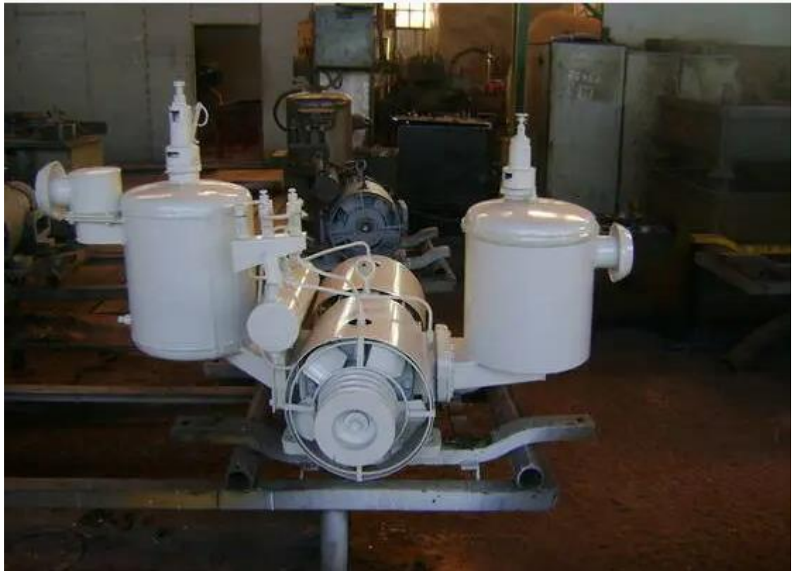
Рис. 1.15 Загальний вид компресора цементовоза ТЦ-10А
