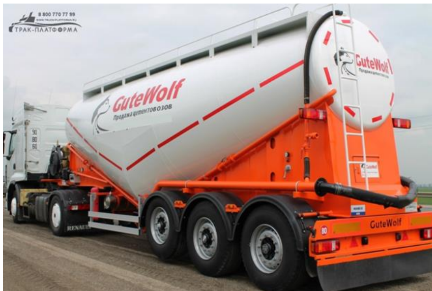
Рис. 1.1 Напівпричеп - цементовоз GuteWolf
