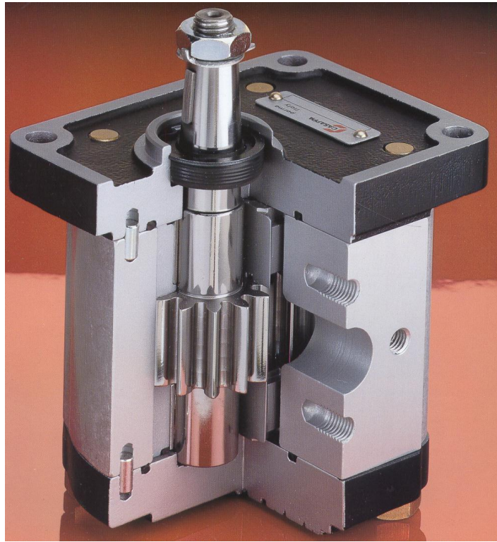
Рисунок 2.1 – Шестеренний насос з корпусом-проставкою і двома кришками.
