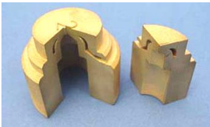
Рисунок 1.5 – Деталь, виготовлена з металу за технологією ProMetal
