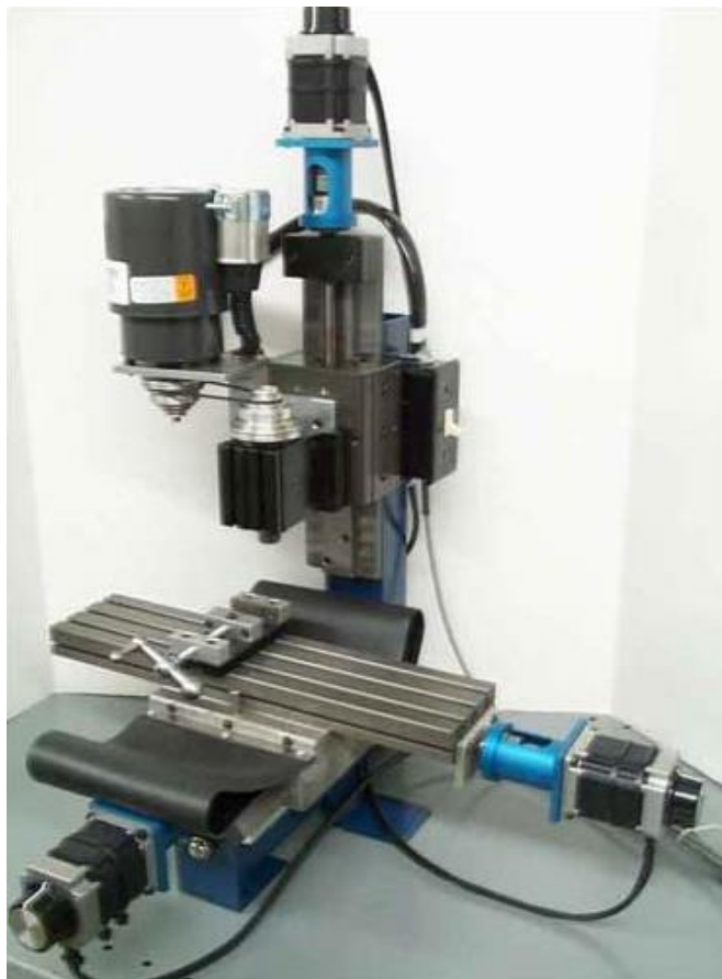
Рисунок 1.1 – Настільний багатофункціональний верстат, який може підключатись до комп'ютера
