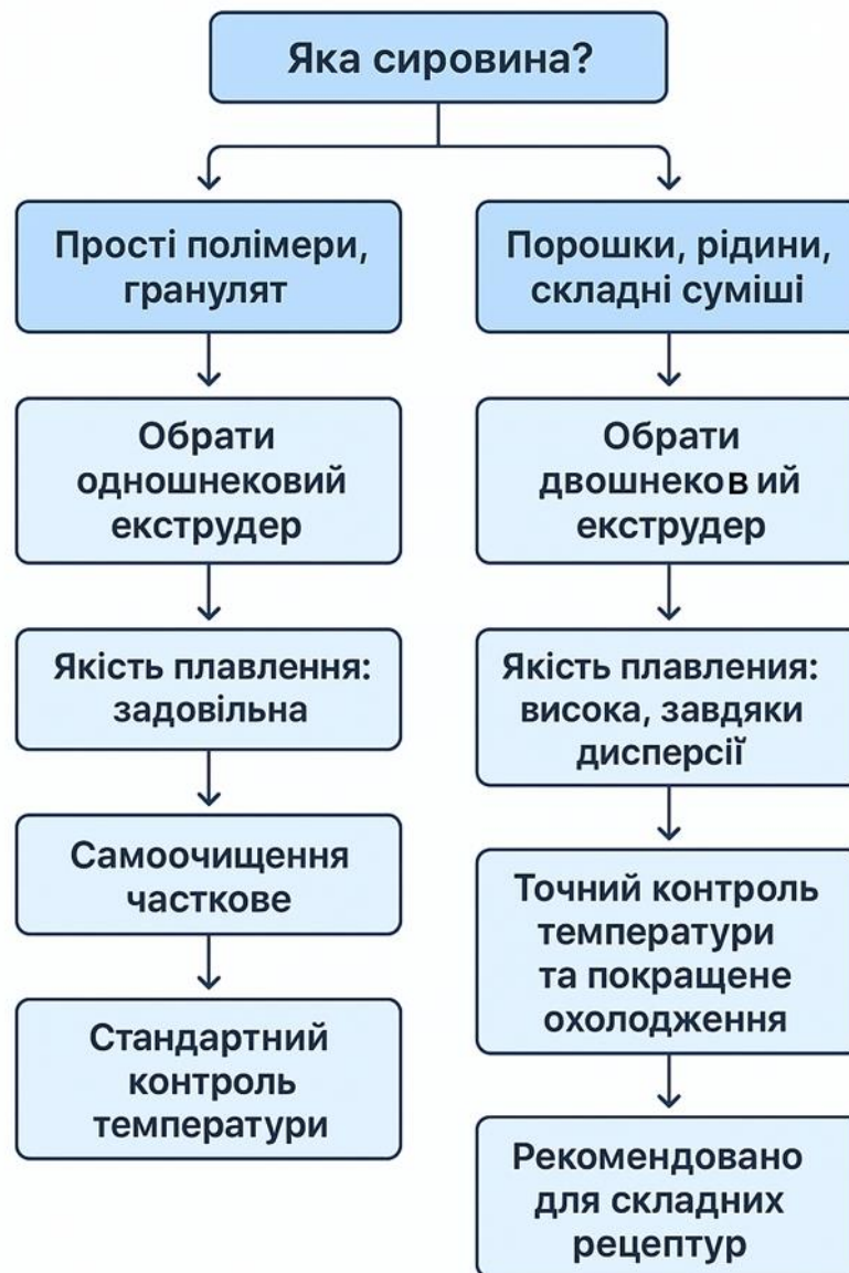
Рисунок 1.8 – Вибір та порівняння типів екструдера
