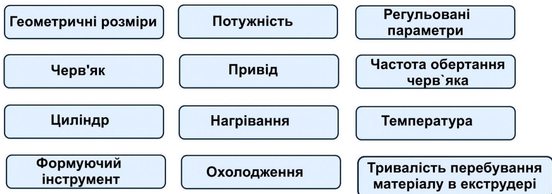
Рисунок 2.1 – Параметри, які характеризують процес екструзії
