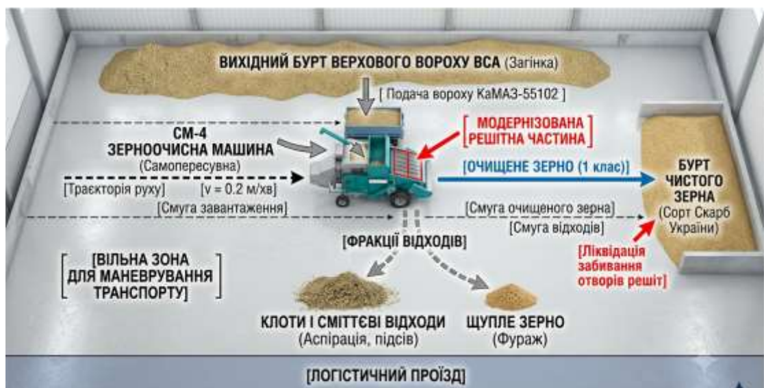
Рис. 3.1. Операційно-технологічна схема організації робіт та руху машини СМ-4 на майданчику току
