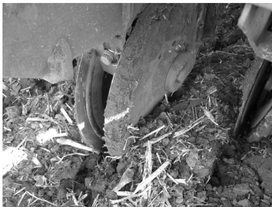
Рис. 2.3 – Дводисковий сошник сівалки GREAT PLAINS з випуклими дисками
