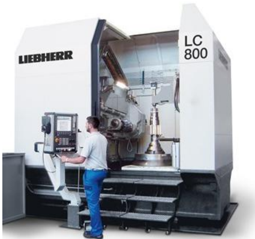
Рис. 1.11 Сучасний зубофрезерний верстат з ЧПУ [25].
