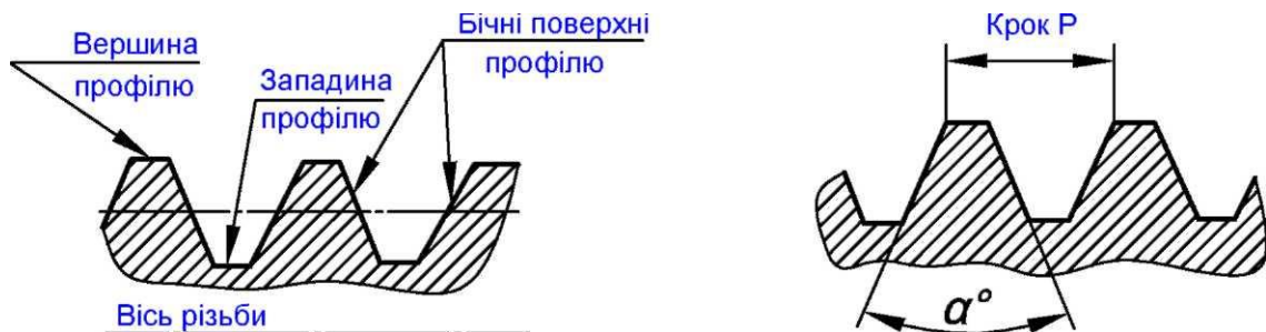
Рис. 1.2 Профіль різьби
