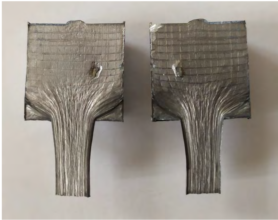
Рис. 16. Прес-залишок для сталої стадії пресування свинцевих зразків через пряму симетричну одноканальну матрицю із гладкого контейнера ( \lambda = 9 )
