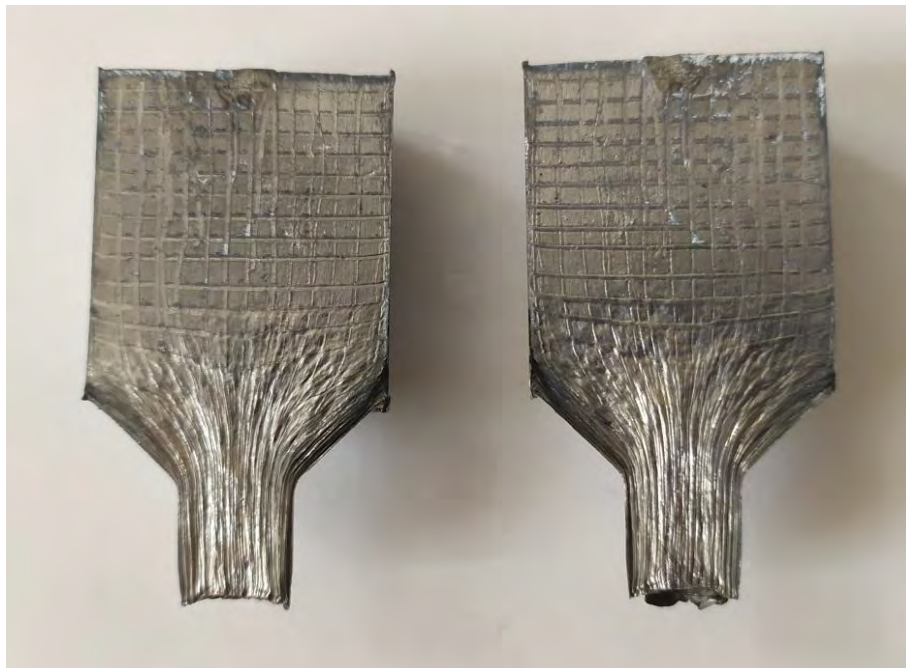
Рис. 18. Прес-залишок для сталої стадії пресування свинцевих зразків через увігнуту по лінії ковзання симетричну одноканальну матрицю із гладкого контейнера ( \lambda = 9 )
