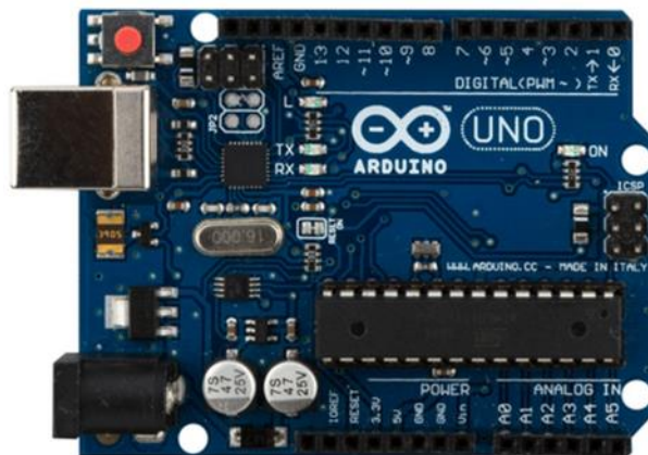
Рисунок 3.2 – Плата Arduino Uno R3
