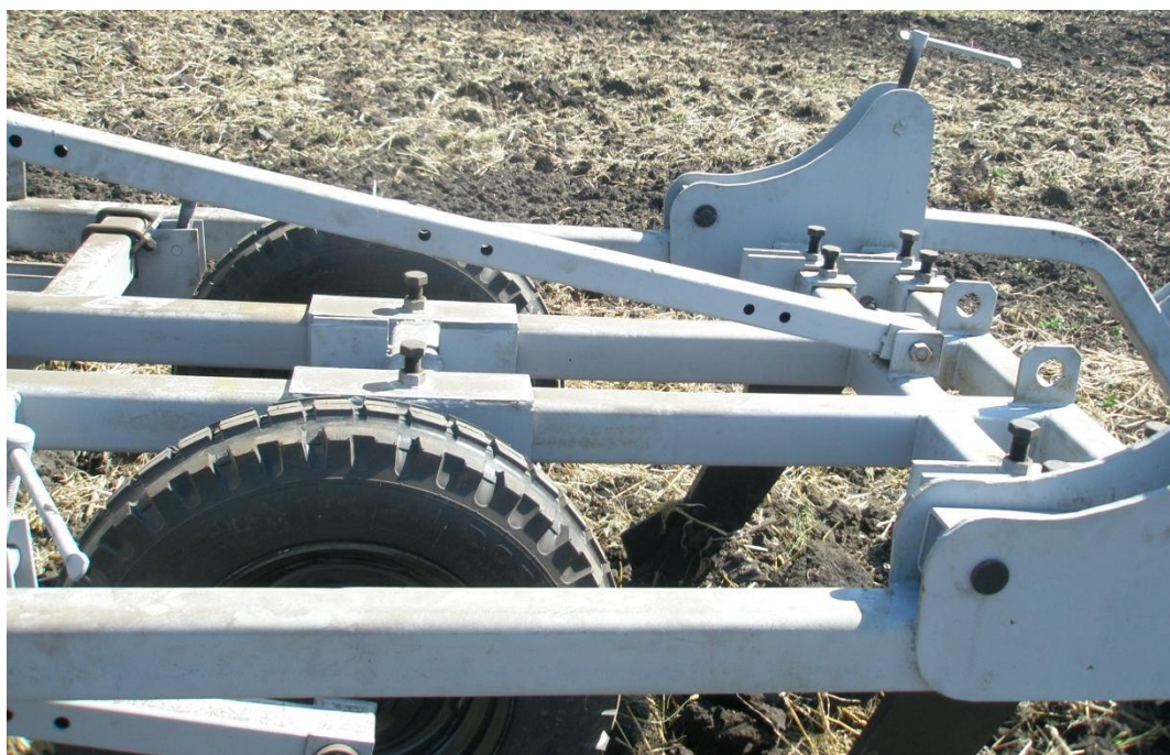
Рис. 3.2. Спосіб кріплення робочих органів до брусів рами
