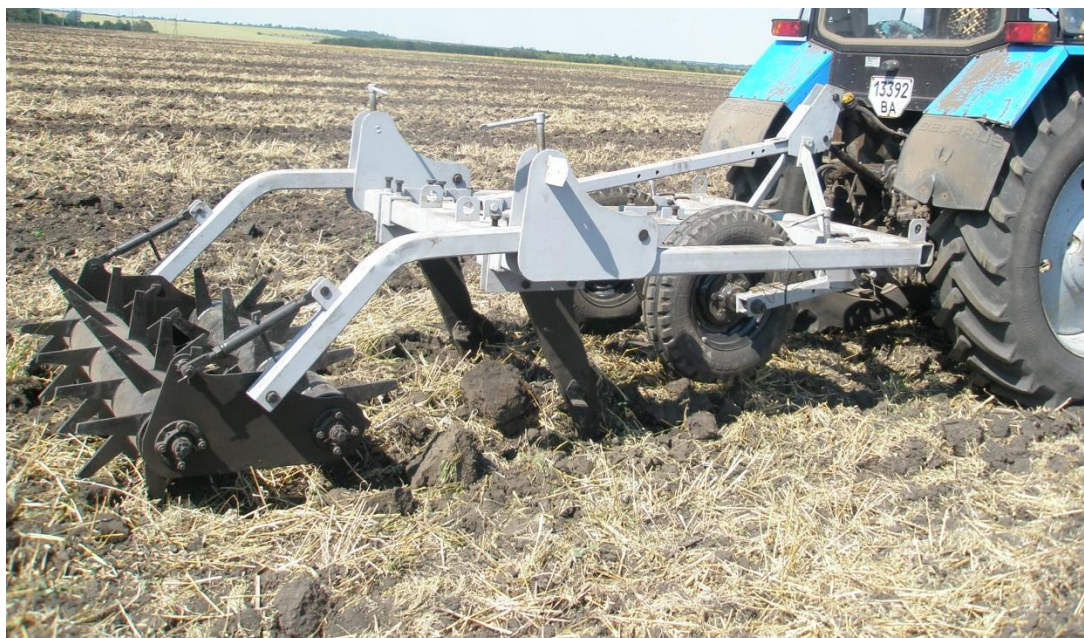
Рис. 3.1. Дослідний зразок глибокорозпушувача при проведенні польових експериментальних випробувань.
