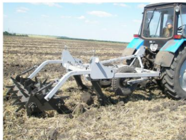
Загальний вигляд глибокорозпушувача на базі якого проводили польові експериментальні дослідження
