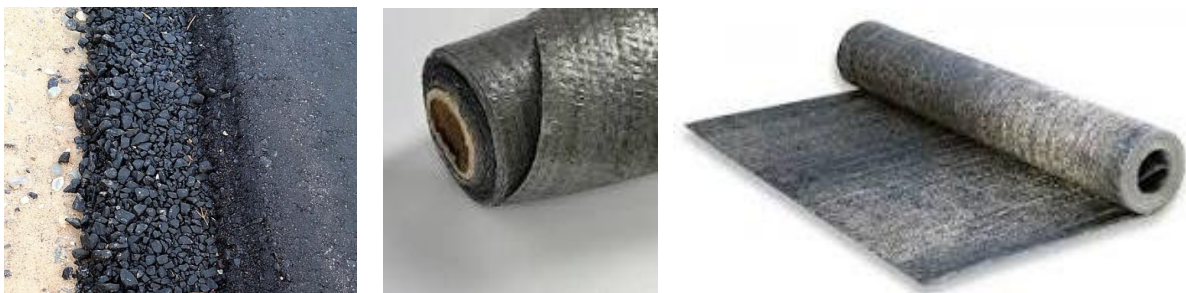
Рисунок 2.21 – Матеріали на основі органічних в'язучих речовин: асфальтобетон, руберойд, гідроізол
