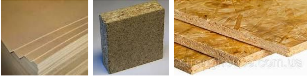
Рисунок 2.20 – Перероблена деревина: плити деревоволокнисті, деревостружкові, OSB
