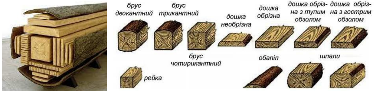
Рисунок 2.18 – Схема розпуску колоди і види пиломатеріалів
