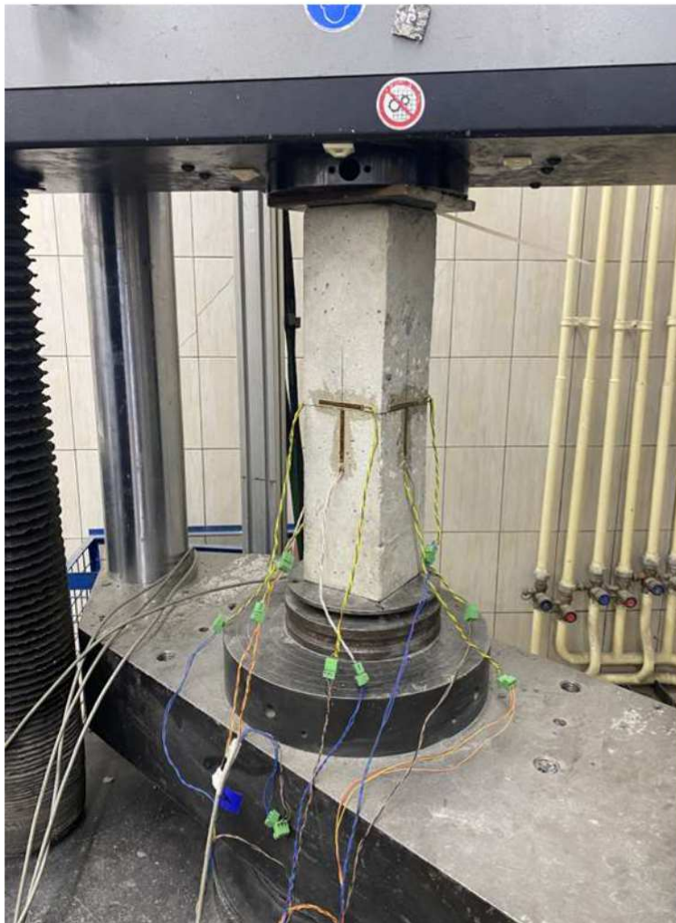
Рисунок 9 -Підготовка залізобетонних балок для випробування механічних властивостей бетону перед прискореною корозією
