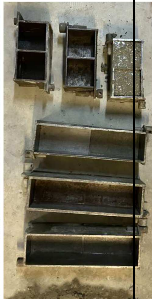
Рисунок 9 -Підготовка залізобетонних балок для випробування механічних властивостей бетону перед прискореною корозією
