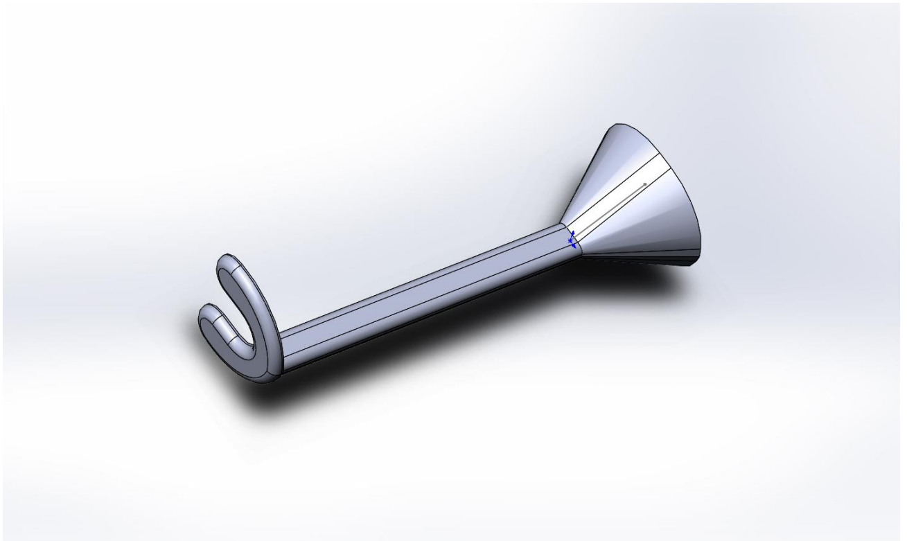
Рисунок 3.7 – 3D-модель ливникової системи
