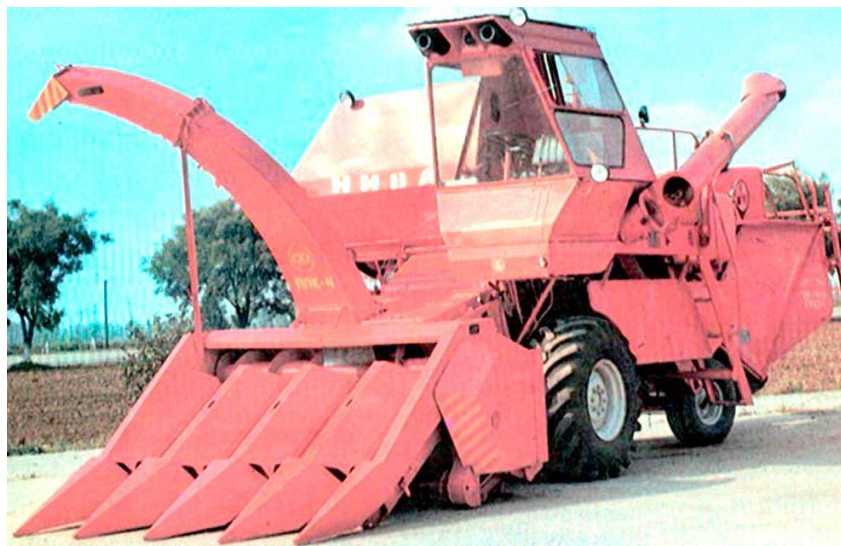
Рис. 2.2. Приставка для збирання урожаю кукурудзи ППК-4 в агрегаті з комбайном СК-5 «Нива».
