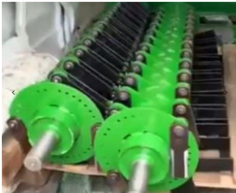
Рис. 3.2. Барабани (ротори) молоткового подрібнювального апарату
