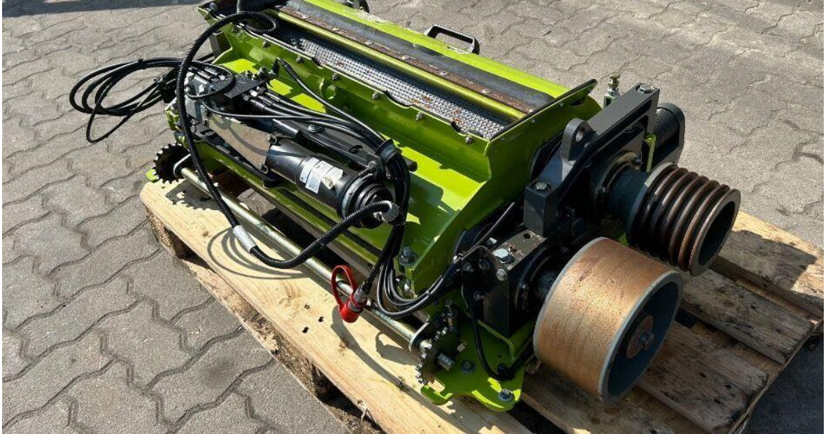
Рис. 3.3. Подрібнювач Claas Körnerprozessor MCC Shredlage до комбайна.
