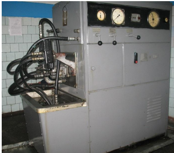
Рис.3.24. Загальний вигляд стенда для стендових випробувань шестеренних гідронасосів
