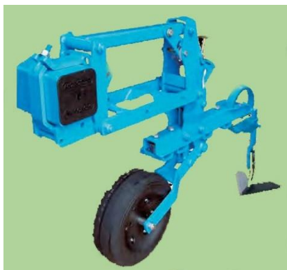
Рис. 3.14. Секції робочих органів культиватора SCD
