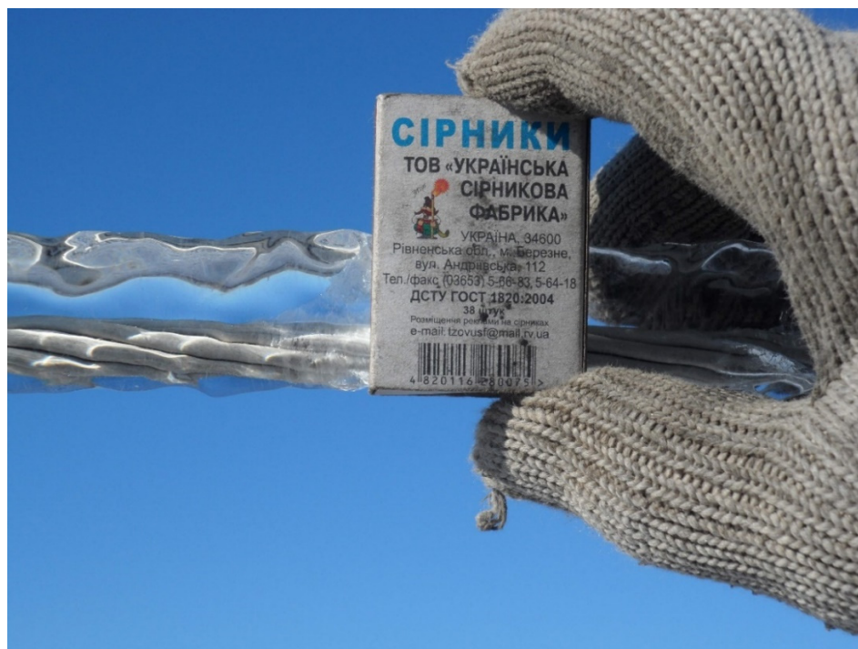
Рисунок 2.1 – Небезпечне відкладення ожеледі на проводі АС-50/8 з максимальним діаметром 30 мм
