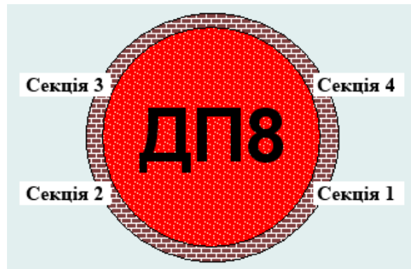
Рисунок 4.6 – Розподілення охолодження шахти печі по 4 секціям
