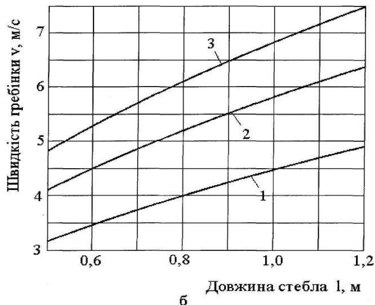
Рис. 4.2. Розроблений графік залежності показника швидкості гребінки \vartheta від дії векторів створених сил P_{від.} та P_{ст.} , а також маси стебла m_c (а) і нарешті, довжини l (б): 1- P_{від.}-P_{ст.}=10\text{Н} ; 2- P_{від.}-P_{ст.}=15\text{Н} ; 3- P_{від.}-P_{ст.}=20\text{Н}
