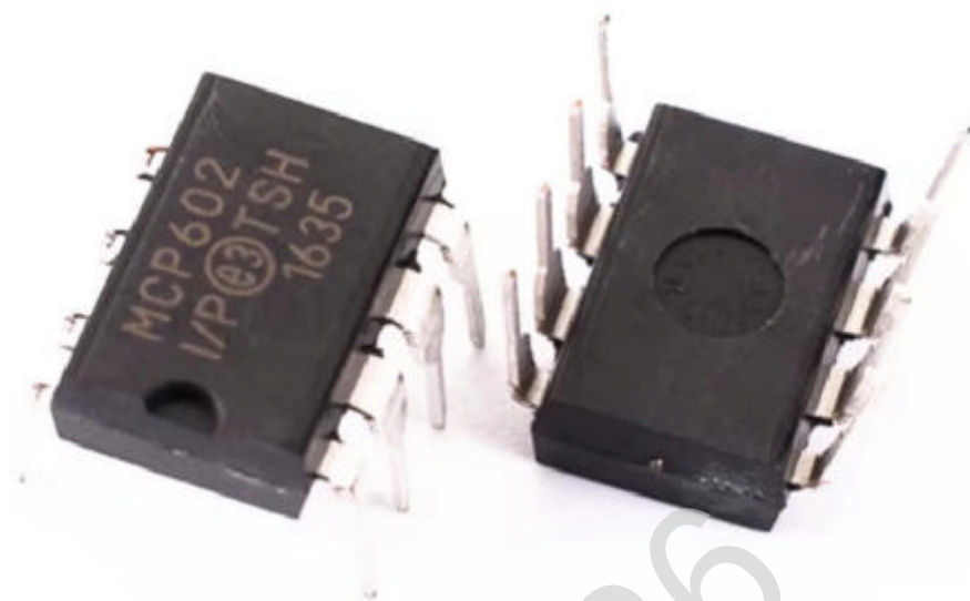
Рисунок 2.7 – Операційний підсилювач MCP602 у корпусі DIP-8
