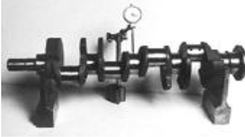
Рисунок 1.2 - Перевірка колінчастого вала на згин.
