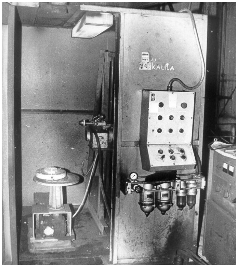
Рисунок 3.3 - Установка електродугового напilenня: 1 - камера вертикальна, 2 - механізм переміщення апарату напilenня, 3 - пульт керування, 4 - апарат дугового напilenня, 5 - стіл поворотний; 6 - система забезпечення повітрям, 7 - джерело струму
