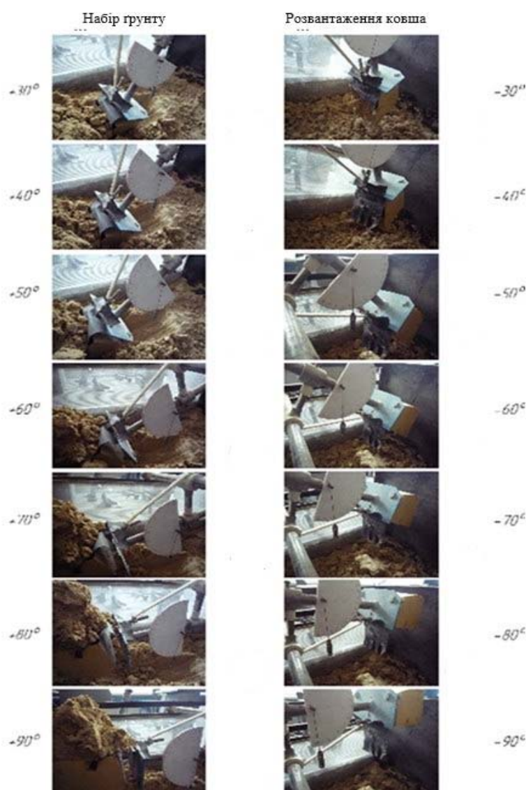
Рисунок 6 – Фотограма завершальних етапів заповнення ковша (кут +30...90^\circ ) і вивантаження ковша (кут -30...90^\circ ) на модельованому ґрунті I категорії з вологістю W=16-18\% .
