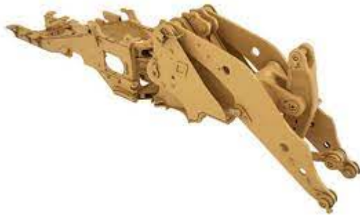
Рисунок 1 – Конструкція рами з листового металу навантажувача Caterpillar
