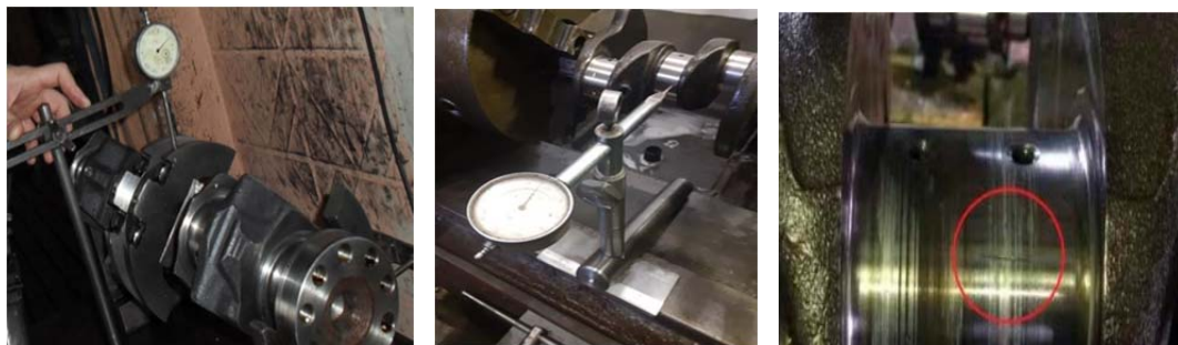
Рисунок 1 - Визначення геометричних розмірів поверхонь валу та виявлення тріщин Джерело: розроблено авторами
