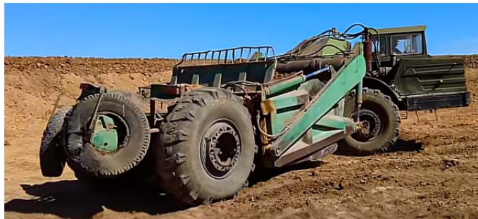
Рисунок 1 – Застосування відпрацьованих автомобільних покришок на буфері самохідного скрепера МоА3-6014, м. Берегово Закарпатська обл. 2021р.
