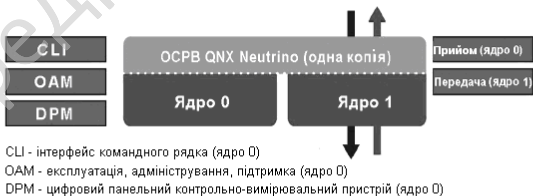
Рисунок 2.4 – Використання виняткової багатопроесорної обробки (BMP) для режимів роботи панелі керування й інформаційної панелі
