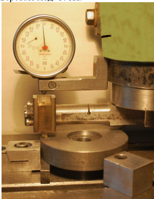
Рисунок 2 – Робоча зона пристрою для нанесення антифрикційного покриття
