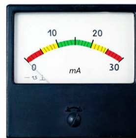
Рисунок 4 – Конструкційна побудова шкали міліамперметра M42300 (розфарбовано авторами)
