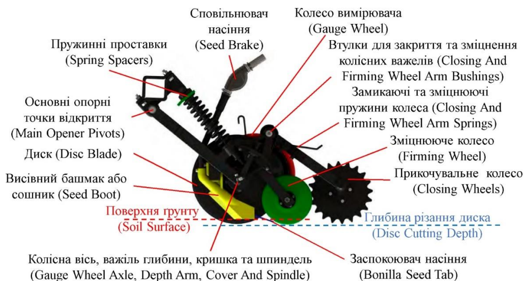
Рисунок 1 – Конструкція висівної секції пневматичної сівалки John Deere
