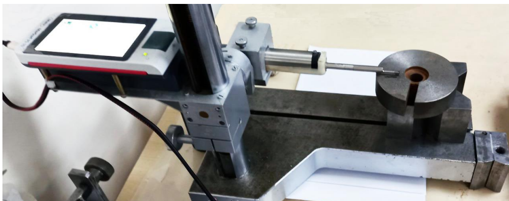
Рисунок 4 – Вимірювання шорсткості поверхні дослідних зразків з використанням профілографа Mahr XR20
