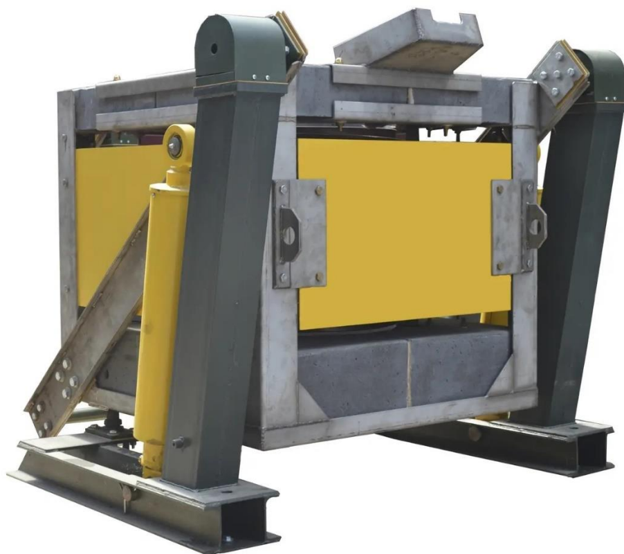
Рис. 1.1. Плавильна індукційна тигельна електропечі ІАТ 2,5/1,6
