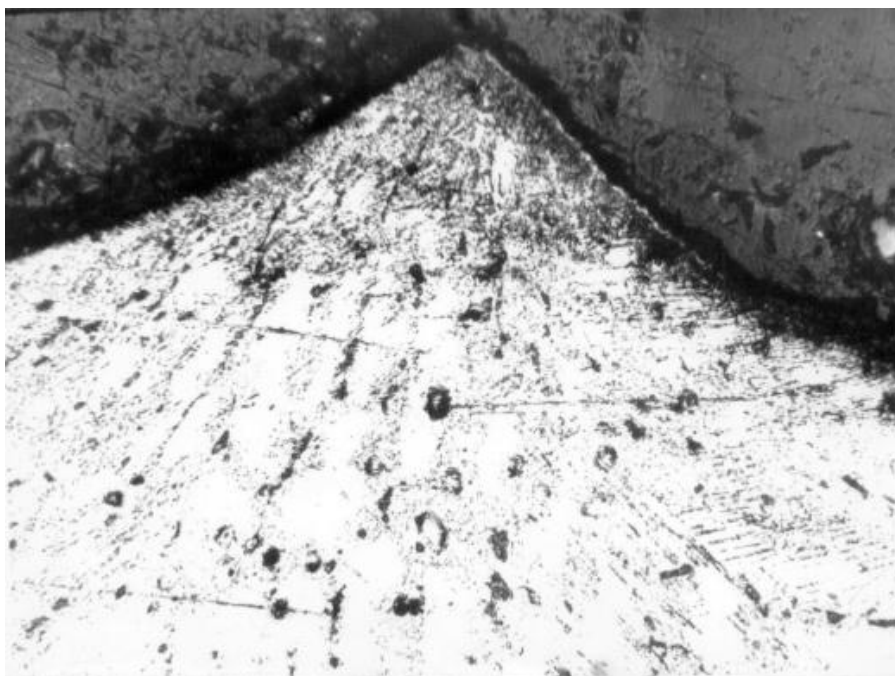
Рис.3.7. Структура бронзи Бр ОЦС 5-5-5 у виступі регулярного мікрорельєфу після вібророзкочування, \times 350
