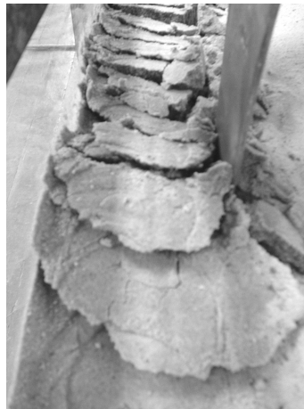
Рисунок 4 – Розповсюдження ліній сколювання від стояка з долотом, що рухається в ґрунті
