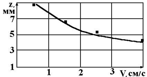
Рисунок 3 – Залежність глибини ( z ) загартованого шару від швидкості обробки ( V ): P = 1 кВт; d_0 = 6,5 мм.
