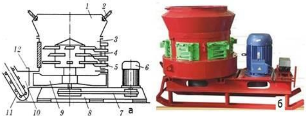
Рисунок 2.3 – Схема функціонування (а) та загальний вигляд ПСК-3А: 1 – приймальник матеріалу; 2 – зрошувач; 3, 10 – камера; 4 – ротор подрібнення; 5 – дека; 6 – привод; 7 – передача приводу; 8 – рама; 9 – вікно вивантаження; 11 – транспортер, 12 – заслінка
