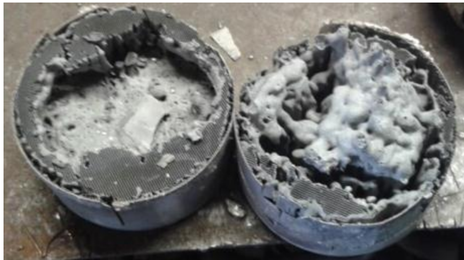
Рисунок 2.14 – Повністю зруйнований каталітичний нейтралізатор.
