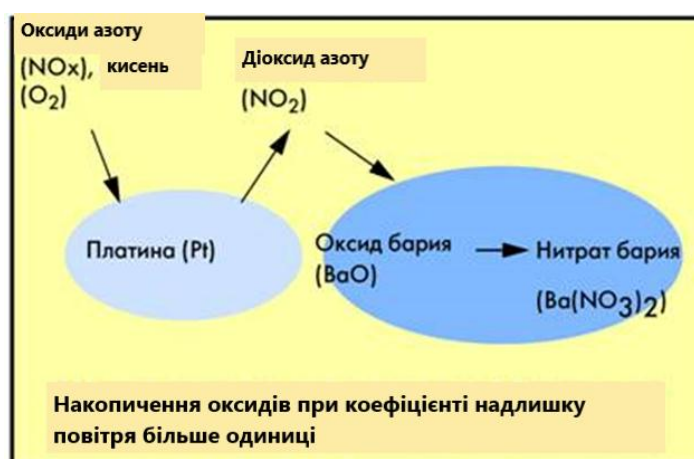
Рисунок 2.9 – Процес накопичення NOX
