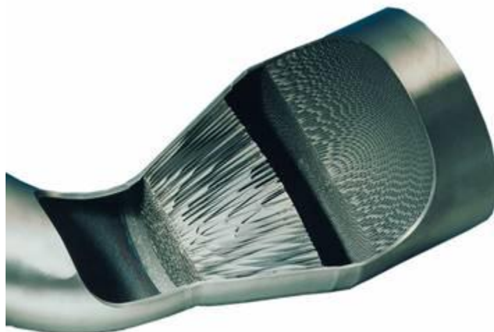
Рисунок 2.5 – Каталітичний нейтралізатор із керамічною підкладкою
