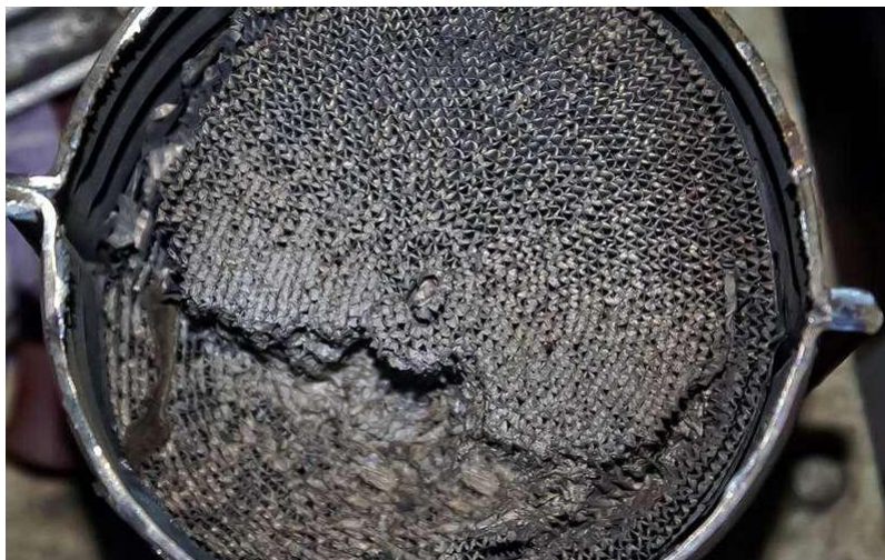
Рисунок 2.12 - Спикання стільників каталітичного нейтралізатора
