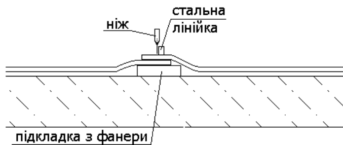
Рисунок 3.5 - Схема прирізки стиків лінолеуму
