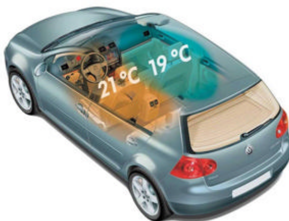
Рисунок 1.1 – Приклад роботи двухзонного клімат-контролю [10]
