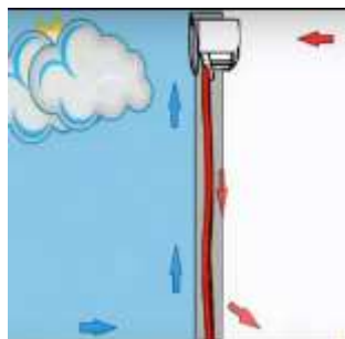
Рис. 3.8. Схема дії теплової завіси
