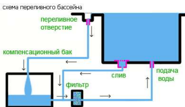
Рис. 3.7.1. Схема роботи переливного басейну
