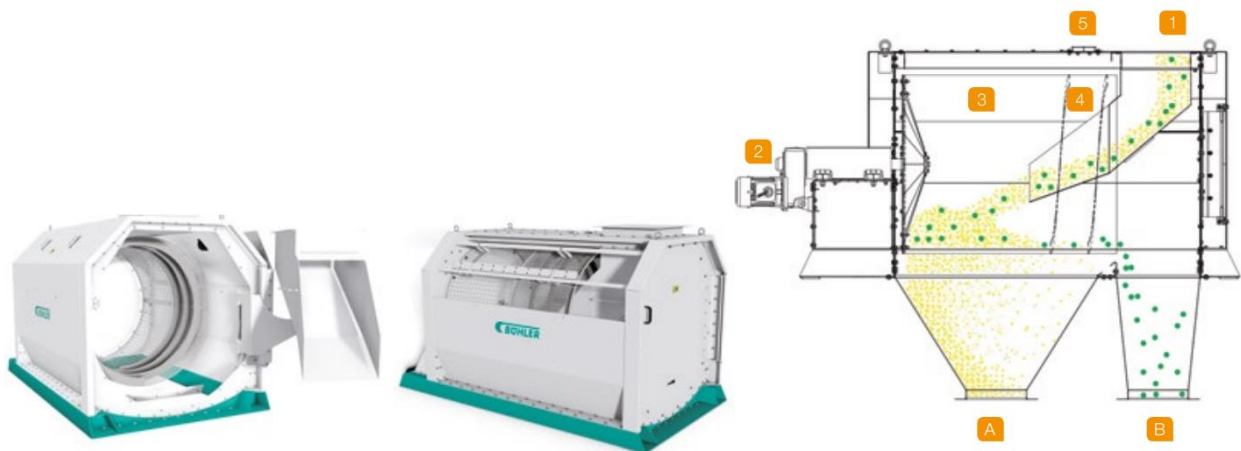
Рис. 2.2. Барабанний сепаратор LAKA від Bühler [3]: а) загальний вигляд; б) функціональна схема: 1 – вхідний патрубок; 2 – двигун; 3 – вхідний циліндр; 4 – вихідний циліндр з напрямним гвинтом; 5 – патрубок для аспірації; А – чисте зерно; В – крупні домішки
