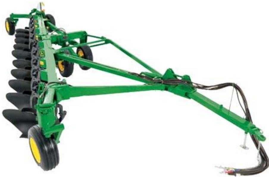
Рис. 3.2. Плуг 6-10-корпусний лемішний (John Deere 3710).
