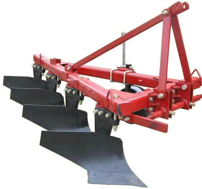
Рис. 3.6. Плуг чотирьохкорпусний начіпний ПЛН-4-35.
