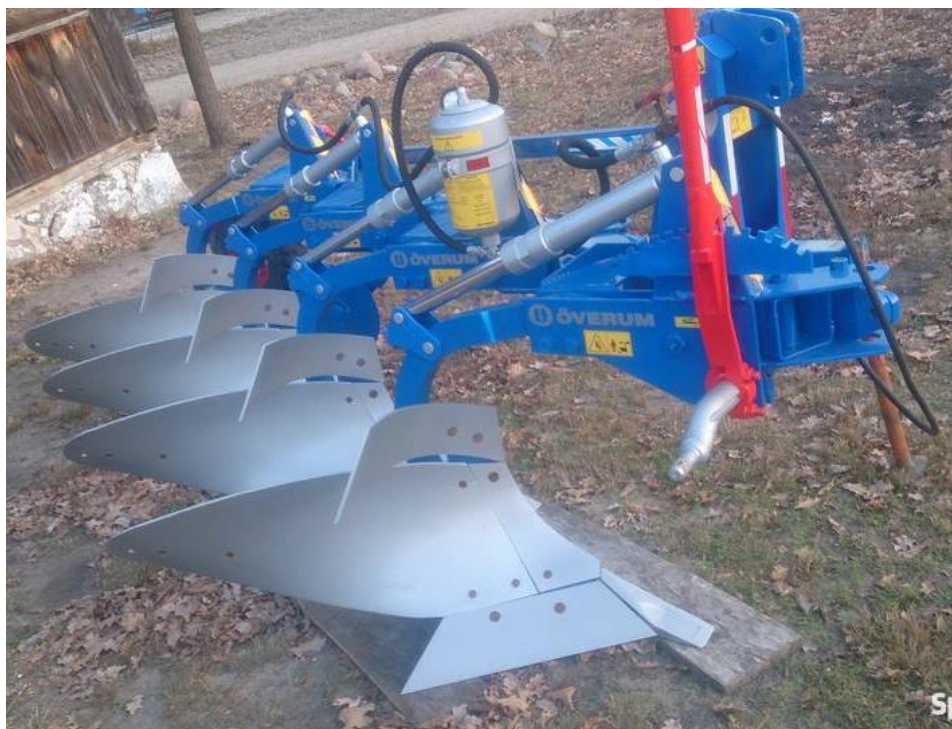
Рис. 3.3. Плуг 4-корпусний Överum
