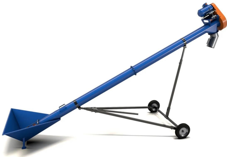
Рис. 2.3. Шнековий транспортер для переміщення сипких вантажів під кутом до горизонту
