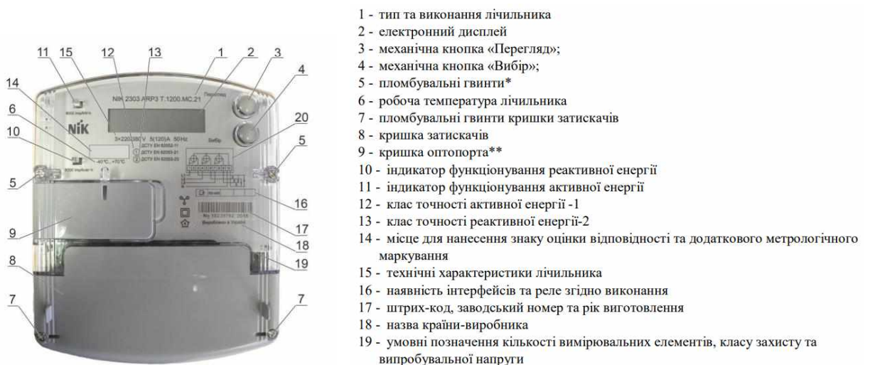
Рисунок 6.2 – Зовнішній вигляд лічильника обліку і розташування елементів управління
