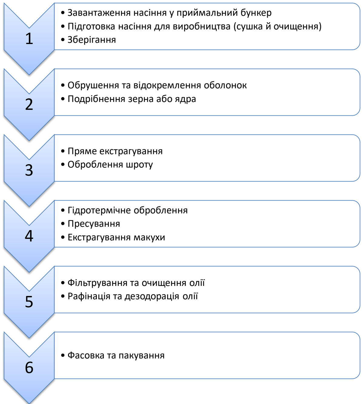
Рис. 3.1. Спрощена схема етапів переробки насіння соняшника у соняшкову олію.
