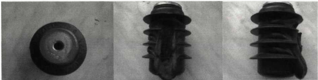
Рис. 4.3 - Типове термічне руйнування ОПН в умовах однофазного замикання на землю
