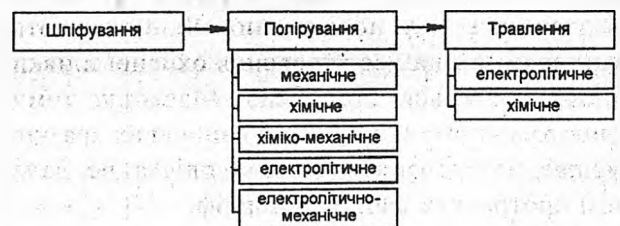
Рисунок 2 — Загальна схема приготування металографічних шліфів металів та сплавів
