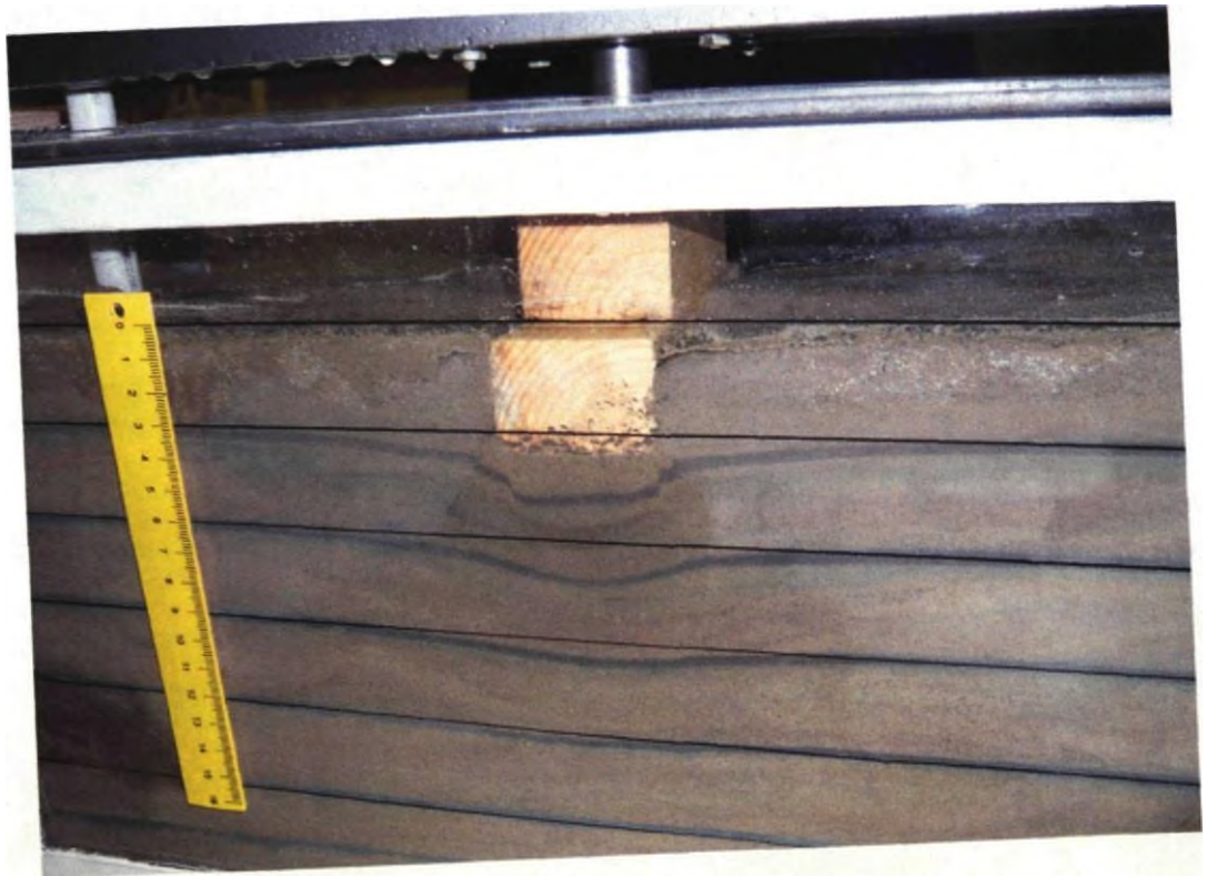
Рис. 2.4. Лоткові випробування штамп на непосиленій основі з позначенням горизонтальних шарів.
