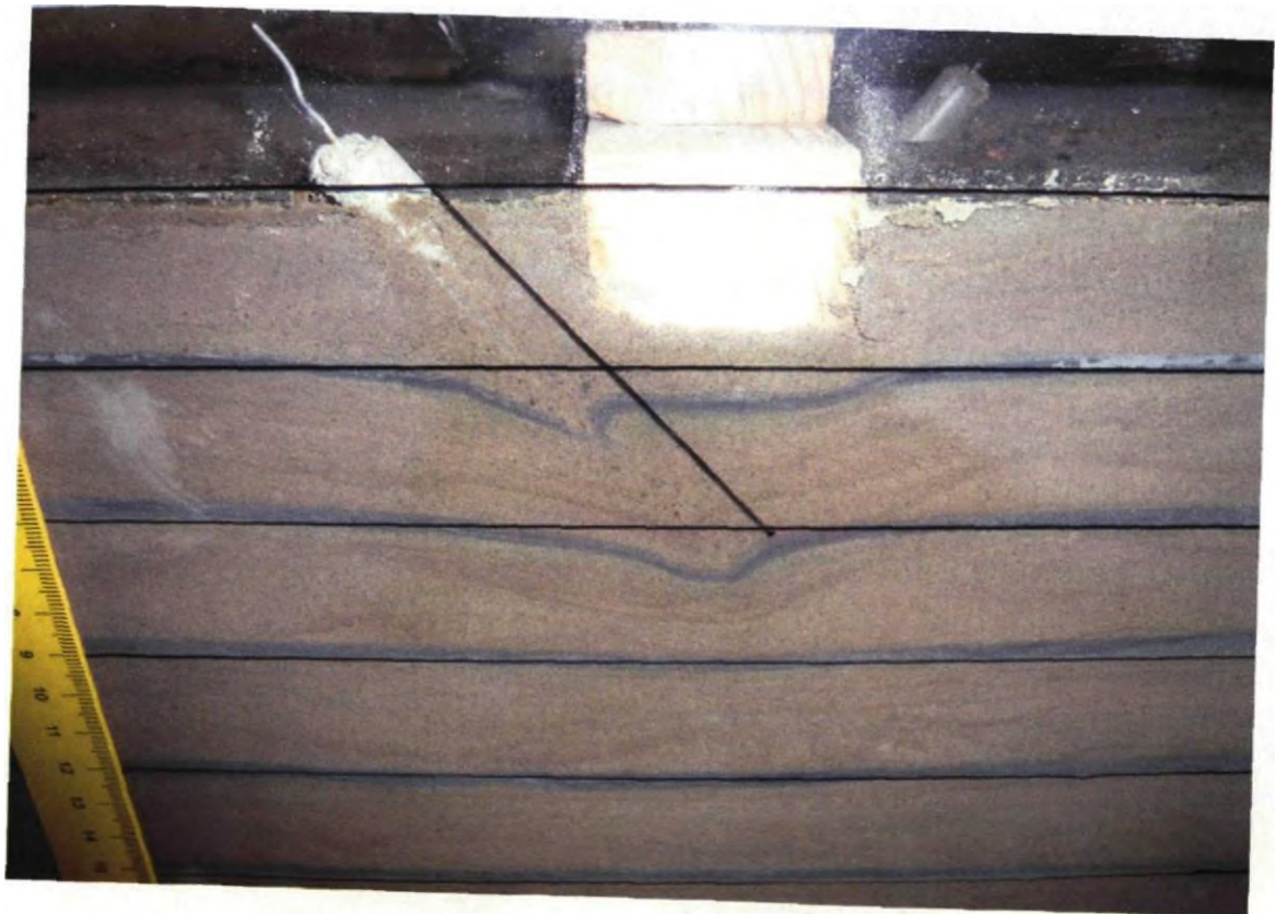
Рис. 2.9. Основа, посилена мікропалями під кутом 45^{\circ}
