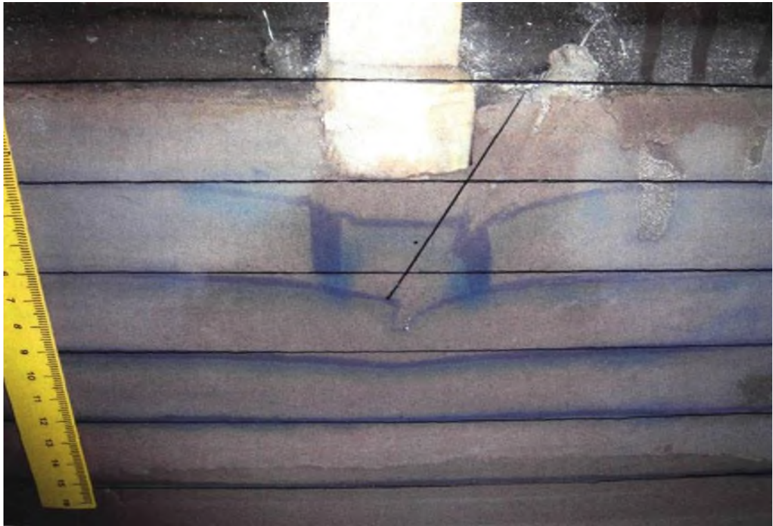
Рис. 2.8. Основа, посилена мікропалями під кутом 30^{\circ}
