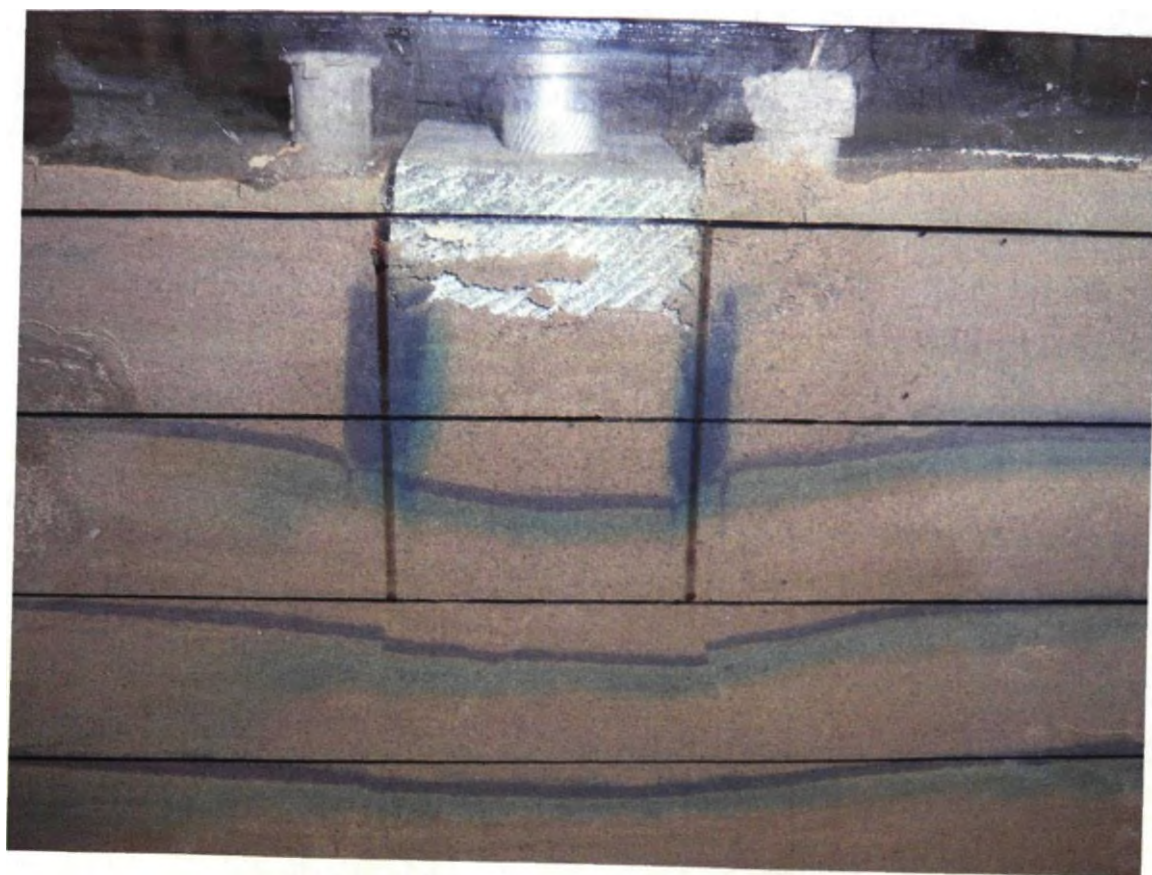
Рис. 2.7. Основа, посилена мікропалами під кутом 0^{\circ} .
