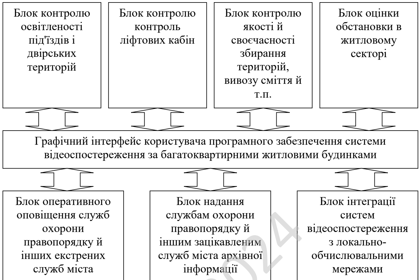
Рисунок 3.2 – Функціональна схема системи
