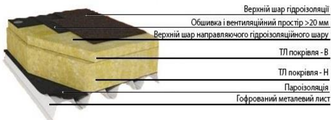
Рисунок 3.7 – Схема утеплення мінеральною ватою
